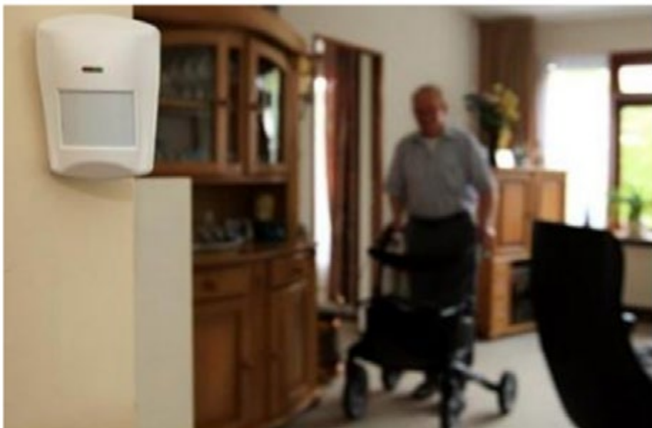
Figuur 1. Sensorische bewaking via een PIR sensor
